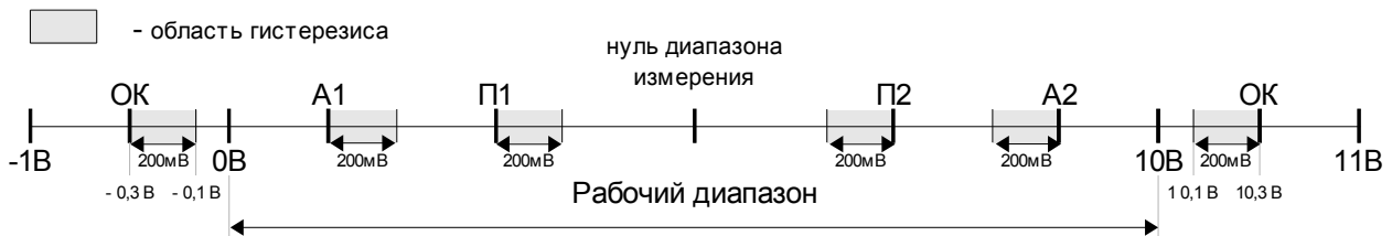
Рис.10. Иллюстрация принципа срабатывания сигнализации.
